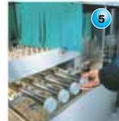
**Blockwaschsystem:** Aus Chromnickelstahl mit reinigungs-technisch optimal dimensioniertem Rohrquerschnitt und konkaver Düsenprägung. Keine bedenklichen Rückwanddurchbrüche - somit keine Undichtigkeiten, auch nach jahrelangem Betrieb. Spielend leichtes Einsetzen/Herausnehmen.
