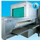
**Schmutzaustrag:** Die gesamte Einlaufwanne ist durch zwei Grobsiebe abgedeckt, welche die herunterfallenden Speisereste auffangen. Ein zusätzliches Feinsieb über dem CSS-Tank hält selbst kleinste Speisereste zurück. Dadurch erheblich verringerte Schmutzbelastung der Waschlafte.
