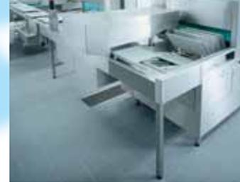
Der **MEIKO-Besteckabhebmagnet** zieht die Besteckteile automatisch von den durchlaufenden Tablettis und läßt sie über eine Besteckrutsche auf die Besteckspur des B-Tronic Bandautomaten gleiten.
