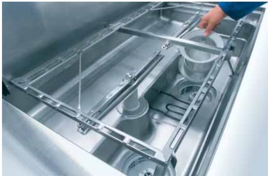
**Das Laugenfeiltersystem AktivPlus.** Es sorgt in Verbindung mit den Tanksieben für eine mehrfache, optimale Waschlaugenfilterung. Das bedeutet länger sauberes Tankwasser und höchste, hygienische Reinigungsqualität.
