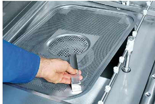
Tankabdecksieb Gezielte Schmutzabführung in den AktivPlus-Feinfilter. Kehrschaufeleffekt bewirkt einfache Beseitigung von Grobschmutz.
