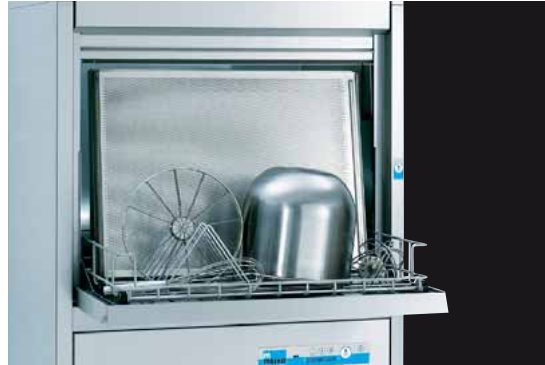
Einfahrtshöhe: FV 130.2 = 740 mm, FV 250.2 = 890 mm Extra hoch für Waschgut, das sonst nirgendwo Platz findet wie z.B. GN-Behälter, Töpfe, Bleche, Arbeitsgeräte.
